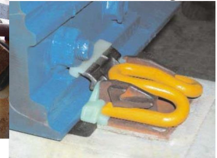
Elastique sans tirefond (attaches e-clip & FastClip)
